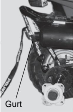
3. Den Gurt straffen, bis sich von der Hinterachse bis zur Getriebeabtriebswelle eine gerade Linie ziehen lässt, die auch durch die Schwingenschwenkachse verläuft. Hierdurch ergibt sich die straffste Ketteneinstellung.
